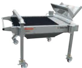
Table de tri mécanique à galets
